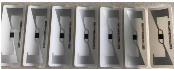
简单身份识别，车辆年检追溯管理、物流供应链数字化仓储、物品防伪及溯源监管，产品外形可根据客户需要定制。该标签一次性使用，防转移防篡改(如加温转移，化学转移，刀片转移等)抗UV紫外线设计，可车内或车外使用
